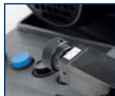
2 Índice coprador con regulación micrométrica.
