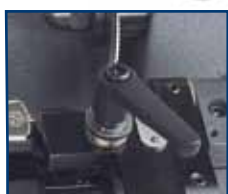
1 Système réversible à double mâchoire, deux positions: a) copie de clés à pompe. b) copie de clés frontales.
